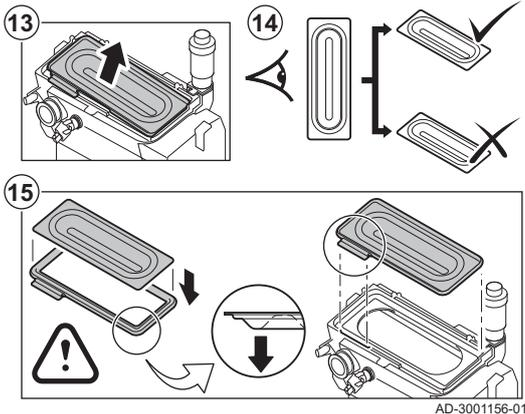
13. Sollevare il bruciatore, insieme con la guarnizione dello scambiatore primario.
