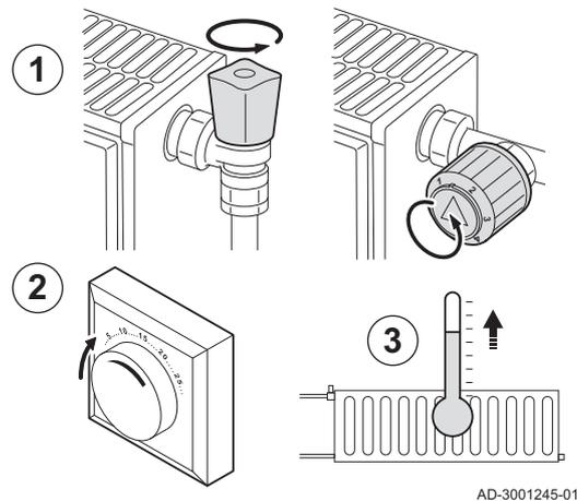
Ogni bolla d'aria nella caldaia, nei tubi o nelle valvole deve essere eliminata per evitare rumori indesiderati che possono verificarsi durante il riscaldamento o durante il prelievo sanitario. Per fare ciò, procedere come segue:
