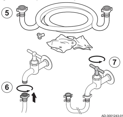
5. Per il rabbocco, utilizzare un tubo di riempimento con due raccordi, un panno e una chiave di degasamento.
