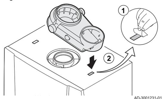
Un adattatore separato per l'uscita fumi/ingresso aria viene fornito insieme alla caldaia. Per la versione parallela, stabilire in anticipo se il sistema di ingresso dell'aria deve essere posizionato a sinistra o a destra rispetto all'uscita dei fumi. Per il montaggio, procedere come segue:
